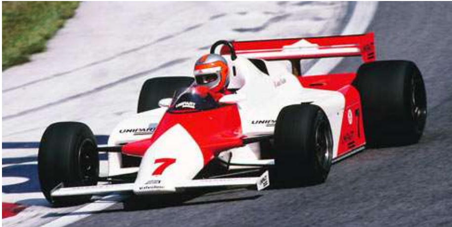
Figura 2: MP4/1, primer monocasco fabricado en composites.
