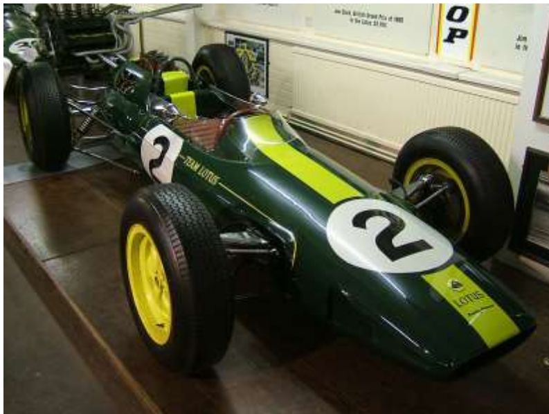
Figura 1: Lotus 25, primer monocasco de competición
